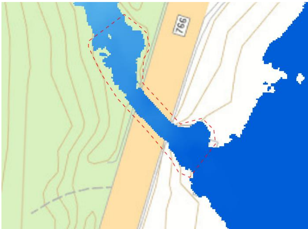
Figur 7-1 Forenklet skisse av nødvendig omfang på erosjonssikring.
