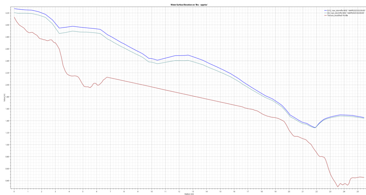
Figur 6-6 Beregnet vannstand i bekken under Hevik bru. 5-års flom er vist med lys blå linje og 10-års flom er vist med mørk blå linje.
