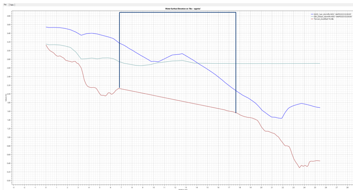
Figur 6-5 Lengdeprofil: Beregnet vannstand i bekken under Hevik bru. 200-års flom er vist i mørk blå linje og 200-års stormflo er vist i lys blå linje. Bru er skissert basert på oversendte arbeidstegninger (Vedlegg 3).
